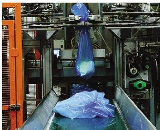
L'impianto di dosatura automatica delle materie prime
